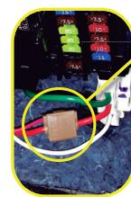
**POSITIVO:** No conector abaixo da caixa de fusível, identifique o fio VERMELHO grosso e interligue o fio VERMELHO do chicote do produto.
