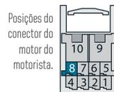
Posições do conector do motor do motorista.
