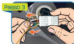
Após travar as travas do terminal e do conector, retire o fio da posição 8 com o terminal (não corte o fio).
