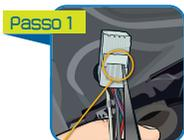
Solte o conector do motor do vidro do motorista, e com o auxílio de uma ferramenta de ponta fina desencaixe parcialmente a trava do conector.
